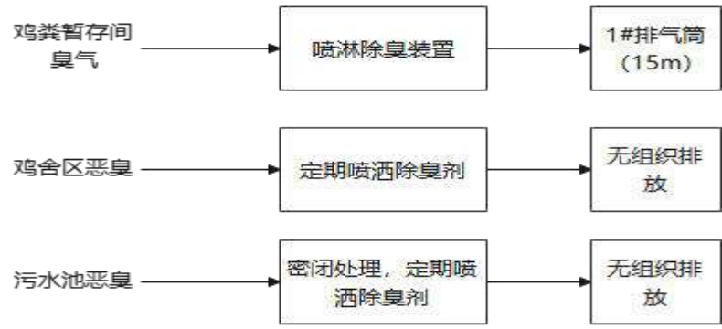
图 4-2 废气产生与治理工艺流程图
