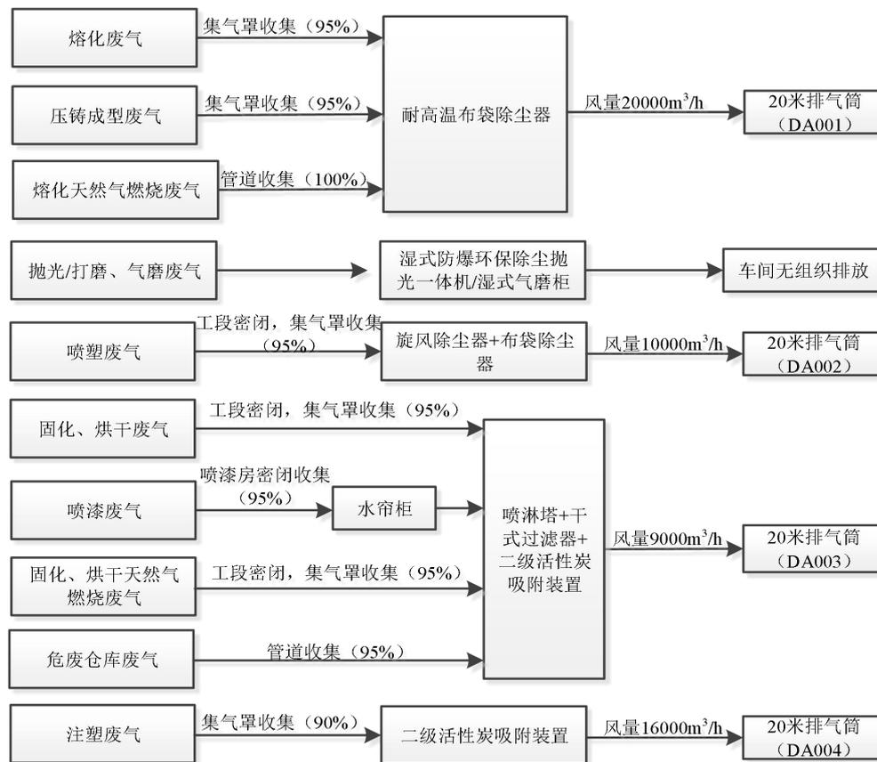
图 4-3 废气处理工艺流程图
